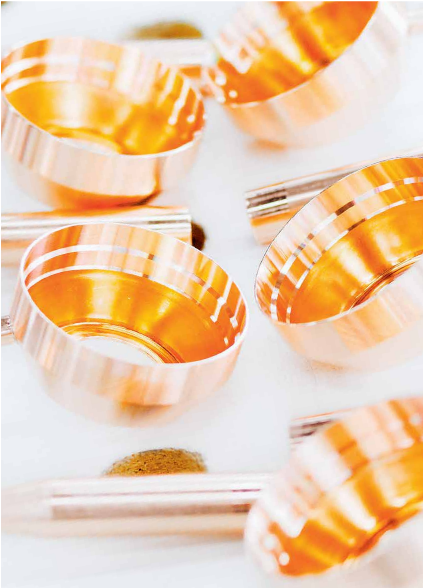
Die noch nicht versilberten Kupferteile eines Vakuumkondensators sind zur Montage bereit.
